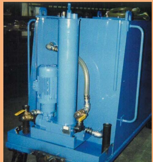
Параллельная фильтрация в действии
